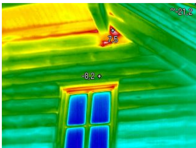
Obr. 4 Únik tepla v oblasti prostupujícího prvku ( IR20100127_1128)
