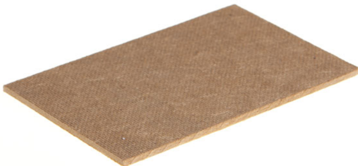
Obrázek 3: Tvrdá dřevovláknitá deska (zobrazena spodní strana desky, na které je patrný otisk odtokového síta, vrchní strana desky bývá hladká)
