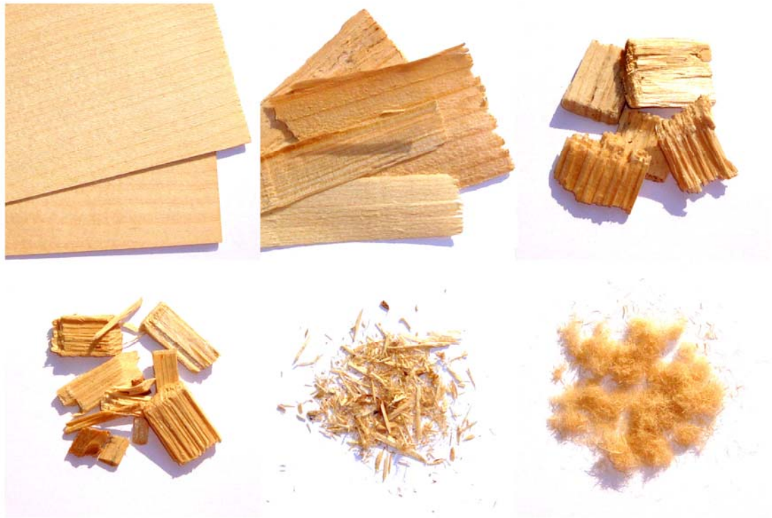
Zleva shora: dýhy, velké ploché třísky pro výrobu OSB, bílá (papírenská) štěpka, štěpka pro výrobu třísek a vláken, třísky, vlákna
