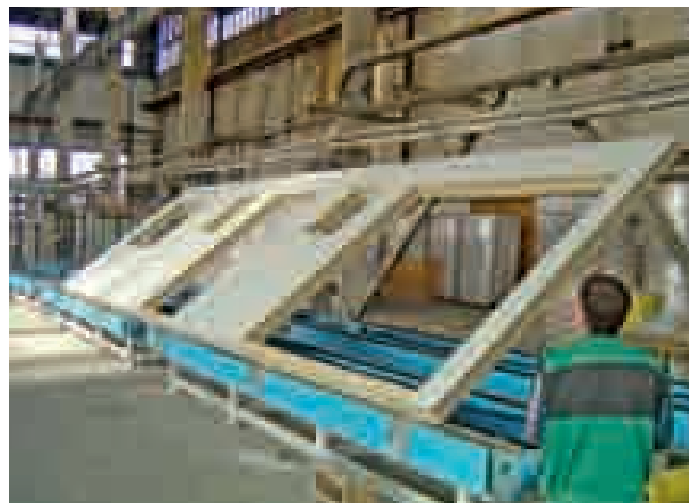
Vybavení výrobní haly – obracení panelu
