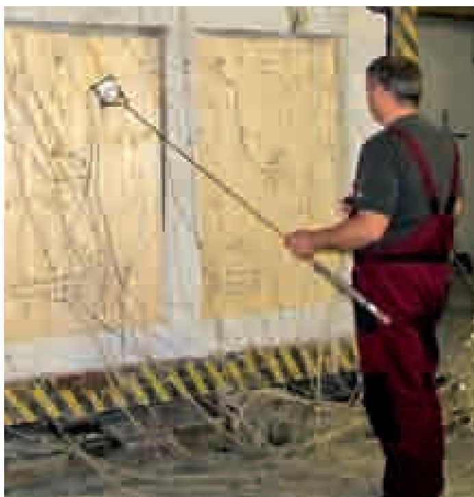
Ověřování porušení kritéria celistvosti bavlněným polštářkem
