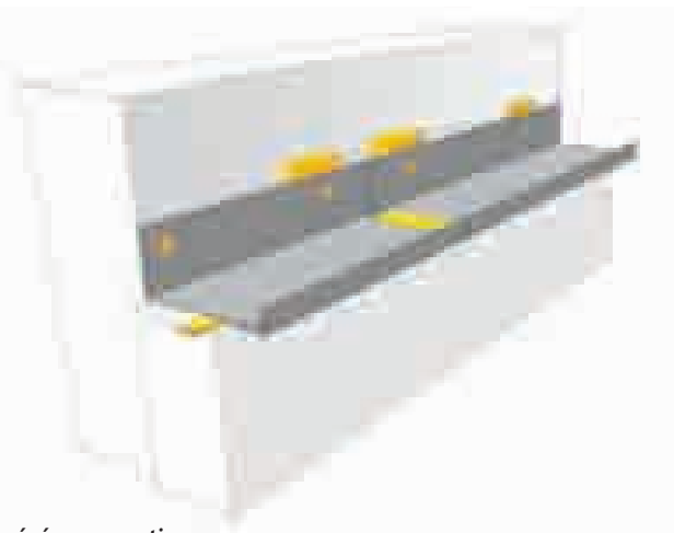
Vyrovnaní nerovnosti stěny pomocí podložek, délkové napojení základacích lišt pomocí spojky a těsnění mezi lištou a izolací soklu – základní předpoklady kvality
