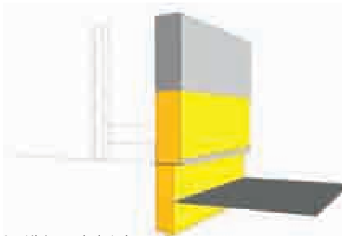
Speciální vrstva hydroizolace nanesená na spodní omítku do výšky min. 30 cm nad terénem
