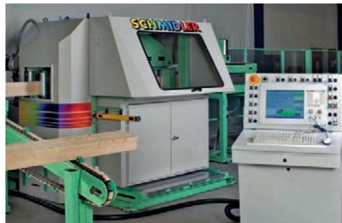
SCHMIDLER „S2“ – kompaktní zařízení pro přířez a tesařské konstrukce, jedno z nejpoužívanějších zařízení současnosti v dřevostavbách, výrobě krovů ale i pro výrobu schodů Foto SOUKUP
