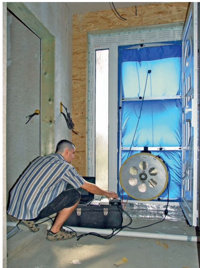
1 – Měřicí aparatura pro blower-door test
