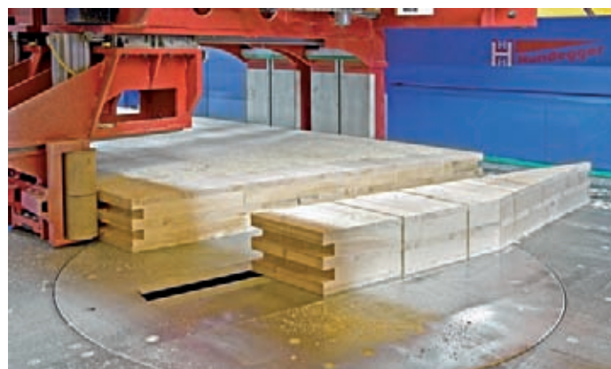
Zařízení Hundegger K2i-1250 umožňuje s milimetrovou přesností a bez nutnosti měření a rýsování opracovávat materiál v rámci sériové i kusové výroby. Využívá jej například společnost Kasper CZ Foto Kasper CZ
