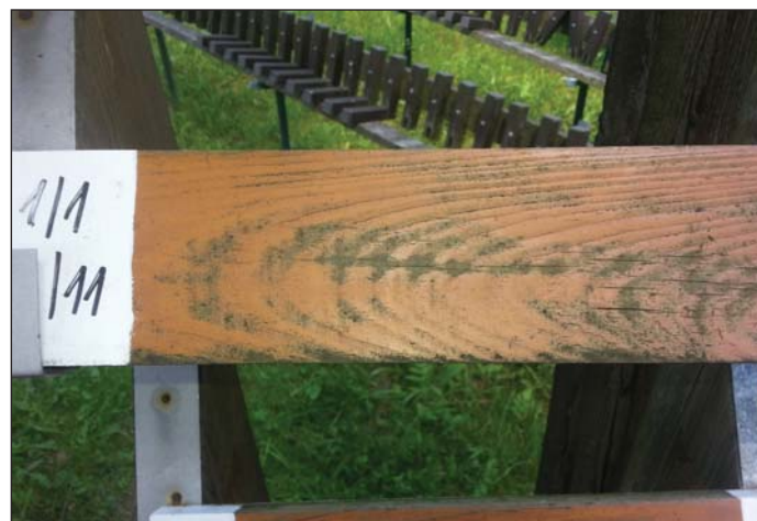
5 Chybějící nátěrový systém spíše z důvodu nevhodného podkladového tělesa s fládrouv kresbou (4 roky)
