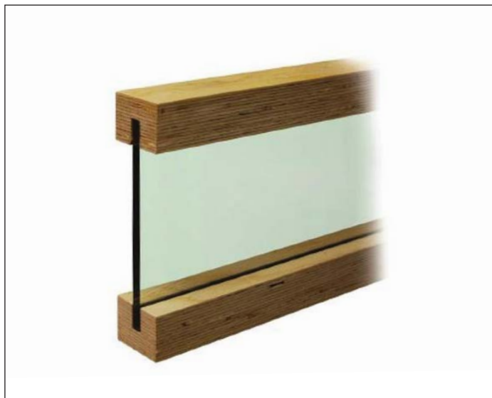
1a Průřez hybridního sklo-dřevěného nosníku s přírubami z bloků z LVL
