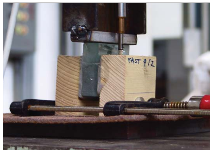
5 Lepený spoj sklo-dřevo během zkoušky
