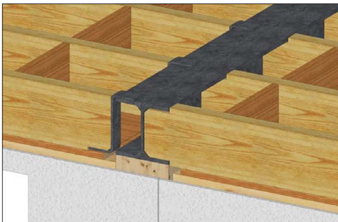
K osazení na stěny byly použity skryté ocelové průvlaky (HEB 240,280) a Z profily
