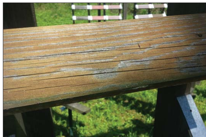
6–8 Plstnatění dřevních vláken na místech chybějícího NS (tenkovrstvá lazura, 4 roky)
