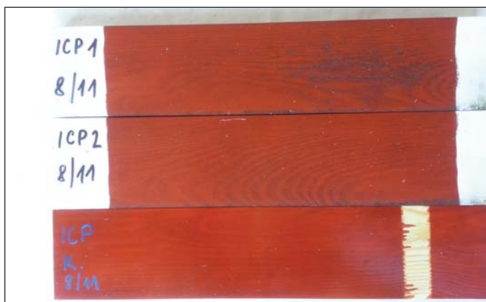
4 Kontrolní těleso a dvě tělesa porovnávacího standardu (3 roky)
